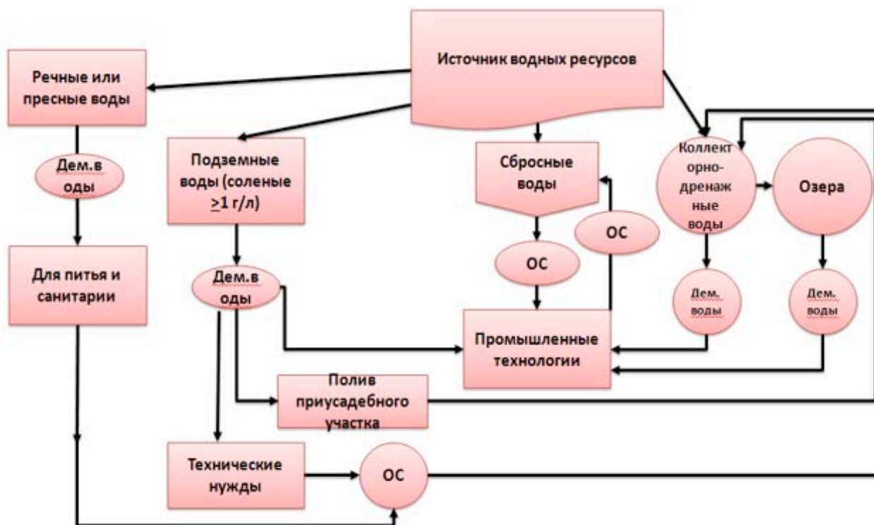
Рис. 2. Усовершенствованная схема комплексного использования и охраны водных ресурсов в крупных промышленных предприятиях.
