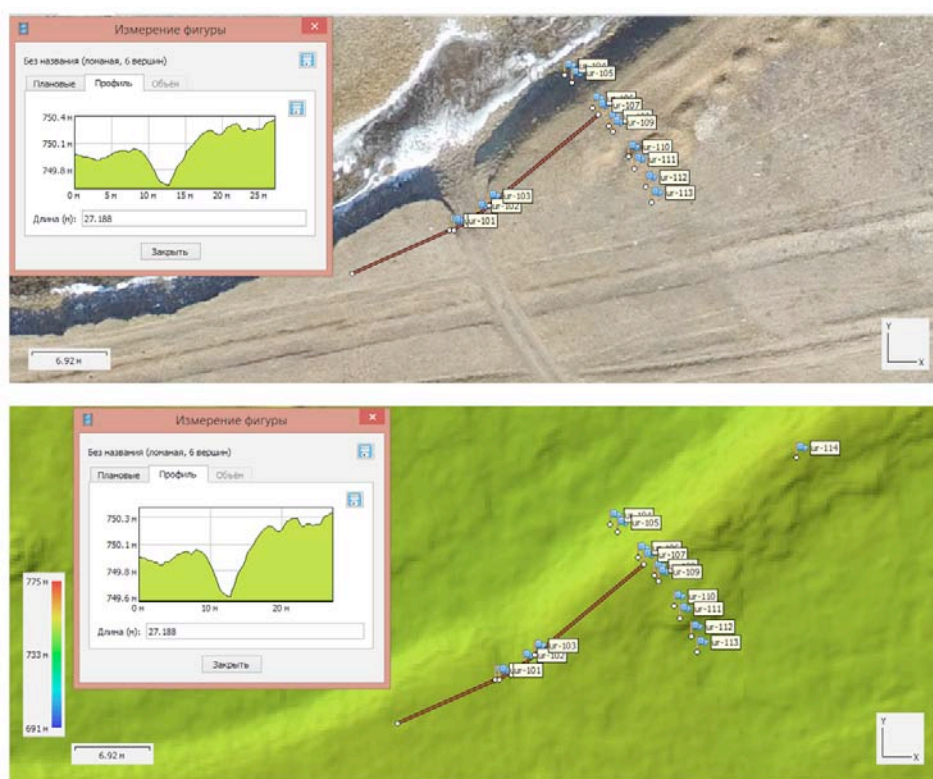
Рис. 3. Продольный профиль участка дамбы в с. Дорожное, показывающий понижение отметок из-за автомобильного съезда.
