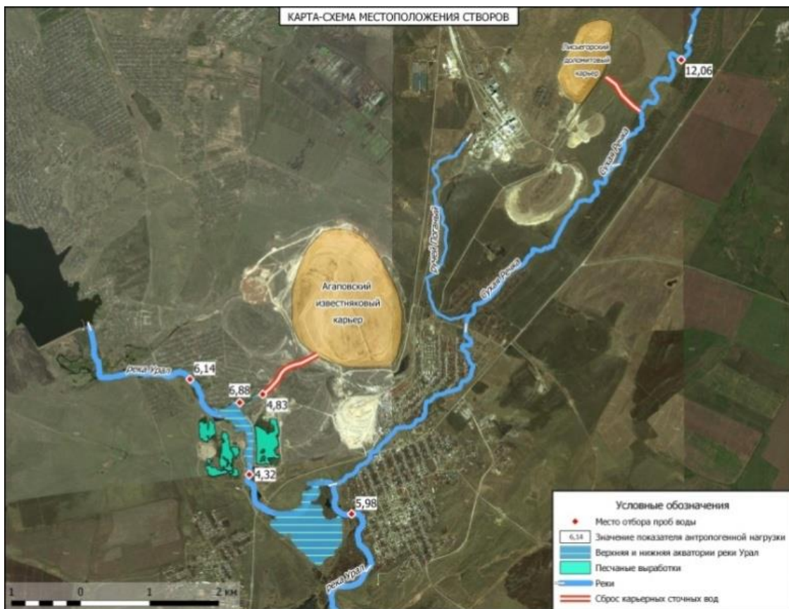
Рисунок. План-схема расположения створов исследования негативного влияния сточных вод Агаповского и Лисьегорского карьеров на качество воды реки Урал.
